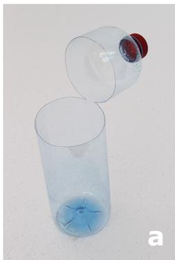
**2** Afin de mesurer la quantité d'eau, il faut graduer le pluviomètre. La manière la plus facile et efficace d'opérer est de s'aider d'un verre mesureur ! Sur une surface bien plane, dose une quantité d'eau de 10 cl (=100ml) avec le verre mesureur et verse la dans la partie basse de la bouteille (b). À l'aide du feutre indélébile marque le trait de jauge sur le pluviomètre (c).
