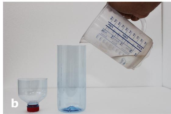
Remets l'eau dans le verre mesureur et complète jusqu'à 20 cl (=200ml). Verse à nouveau dans le pluviomètre, et marque un deuxième trait de jauge. Réitère ces étapes pour graduer entièrement le pluviomètre.
